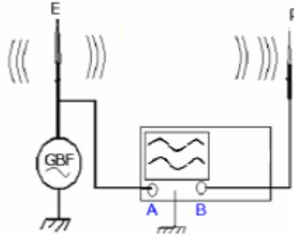
يبعث الهوائي الباعث موجة كهرمغناطيسية لها نفس تردد الإشارة الكهربائية التي أحدثت على مستواها. وتنتشر هذه الموجة في الهوائي المستقبل إشارة كهربائية لها نفس التردد.
